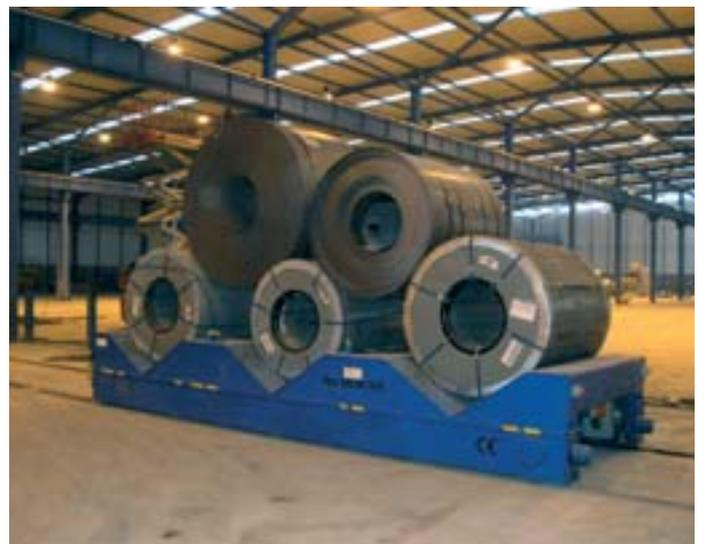
Carros con una o varias cunas para bobinas o completamente planos para matrices o cualquier otro material, capacidades hasta 60 t. Posibilidad de ser totalmente autónomos alimentados por baterías y comandados por botonera de cable o radiocontrol para todos sus movimientos.
