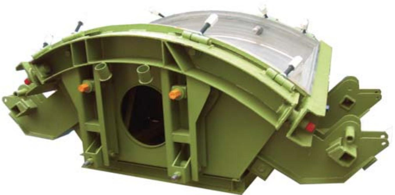
Molde para prefabricar dovelas para túneles
