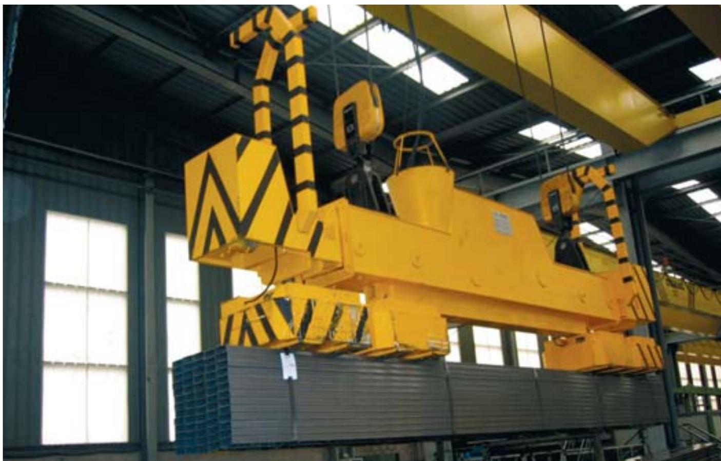
Electroimanes diseñados para la manipulación y transporte de paquetes de tubo (opcionalmente al balancín se le puede dotar de brazos de seguridad)
