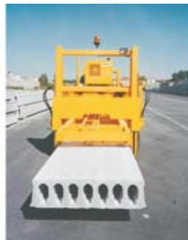
Carros autopulsados para la manipulación de viguetas y piezas prefabricadas
